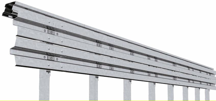
Die MegaRail sk ist das Streckensystem aus der MegaRail Produktfamilie mit kleinem Wirkungsbereich in den Aufenthaltstufen H2 und H4b. Zusammen mit der MegaRail bk ist die durchgängige Verwendung am Fahrbahnrand, im Mittelstreifen, in Mittelstreifenüberfahrten und auf Bauwerken gewährleistet. Begutachtete Übergänge auf Super-Rail und MegaRail s sind verfügbar.
