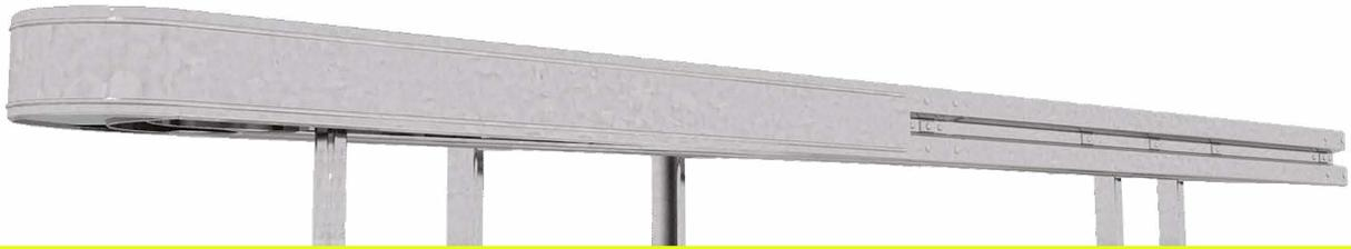
Das 8,22 m lange Terminal Primus P2 ist eine geprüfte Anfangs- und Endkonstruktion, die anstelle der sonst üblichen 12 m langen Absenkung eingesetzt werden kann. Ein Aufgleiten wird im Gegensatz zu den Absenkungen wirksam verhindert und das Fahrzeug bei einem Unfall durch die Deformationselemente sicher abgebremst und umgelenkt. Dies kommt besonders an den Stellen zum Tragen, wo der Platz begrenzt ist und die notwendige Vorlänge an einer Gefahrenstelle nicht erreicht werden kann.
